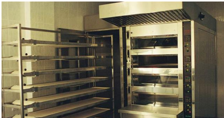
Slika 31. Pekarska peć, komora i kolica s poteznim aparatima
