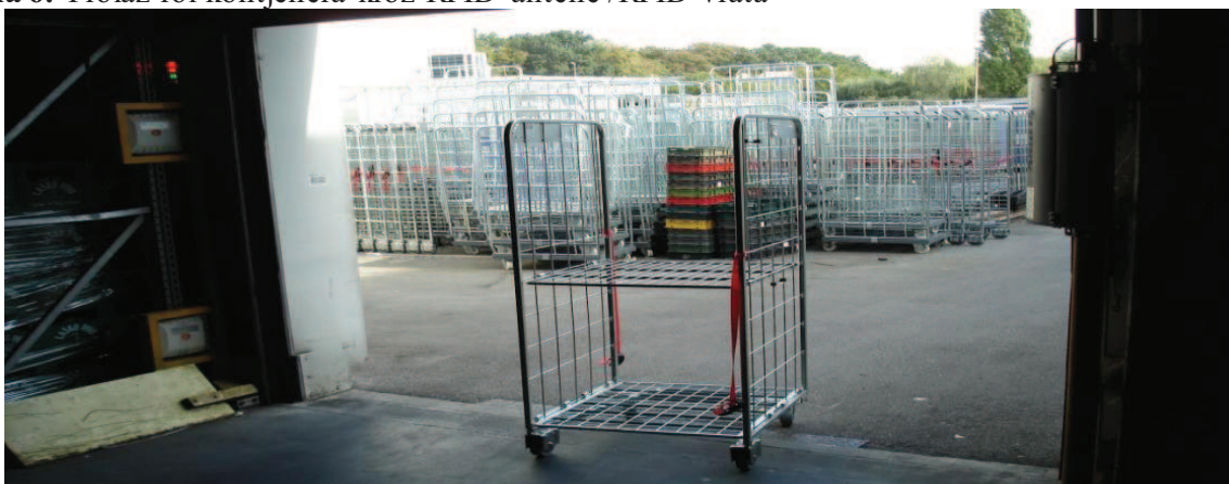
Slika 6. Prolaz rol-kontejnera kroz RFID antene /RFID vrata
