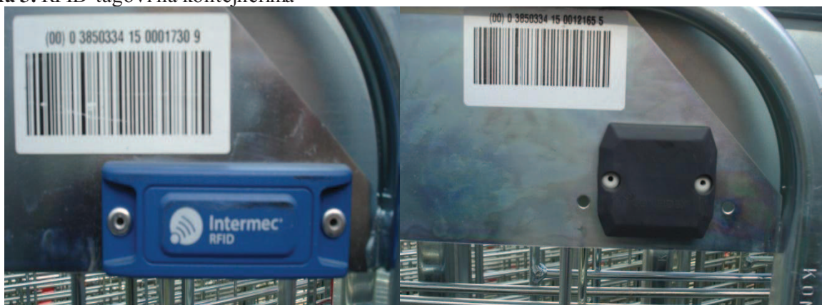
Slika 5. RFID tagovi na kontejnerima
